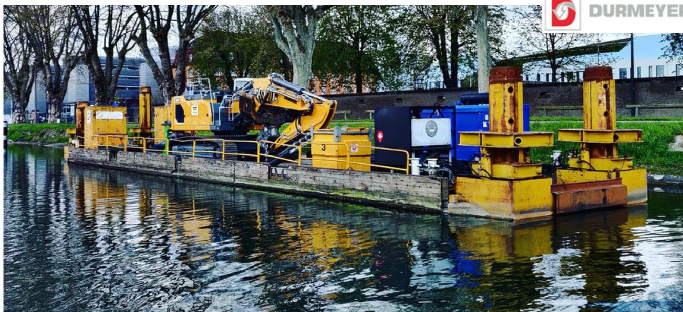
Plateforme louée en partenariat avec l'entreprise DURMEYER. Composée de plusieurs caissons Ravenstein CP-4084 (fiche technique), avec de multiples configurations possibles.
